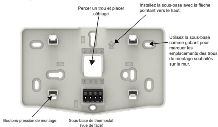
**IMPORTANT:** Étanchéifier le trou dans le mur pour éviter que l'air chaud ou froid n'affecte le capteur de température interne du thermostat.
