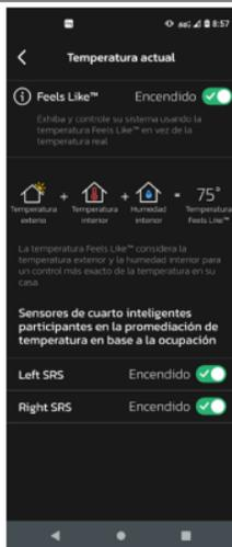
**Figura 8. Pantalla de temperatura actual de la aplicación Termostato inteligente**
